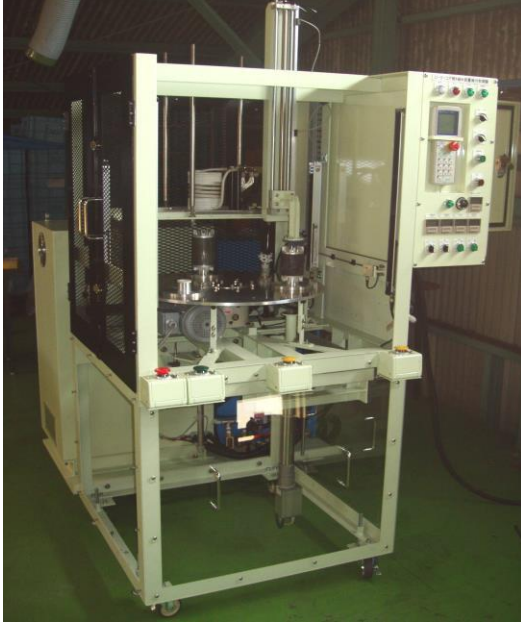
ローターコア焼き嵌め装置 ターンテーブル方式 高周波誘導加熱方式
