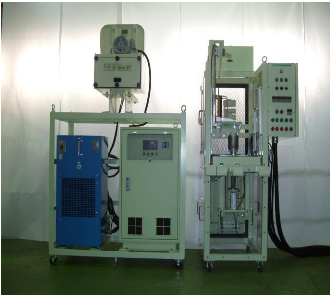
ローターコア焼き嵌め装置 横行式 高周波誘導加熱方式
