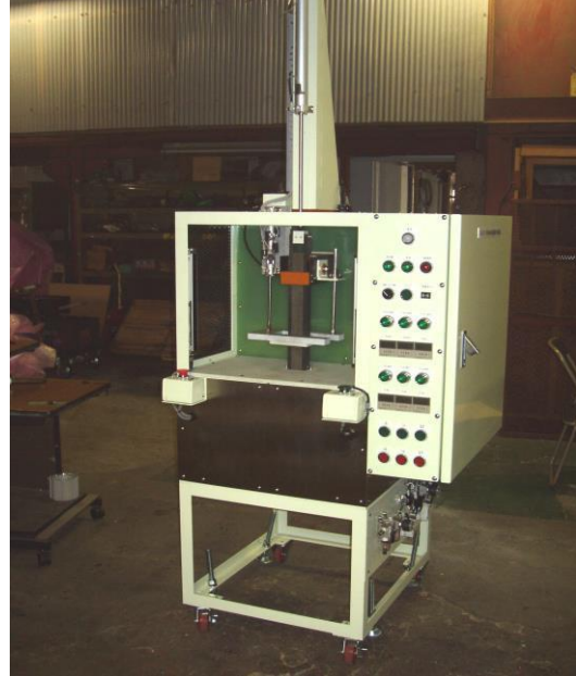
アルミフレーム焼き嵌め装置 昇降式 低周波誘導加熱方式
